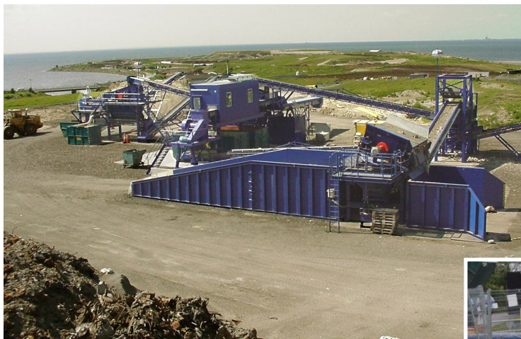
Figur 8.12. SYSAV:s sorteringsanläggning för bottenaska på Spillepeng i Malmö (ovan) och exempel på användning av SAM-produkten ASFALTBär i Kista norr om Stockholm.
